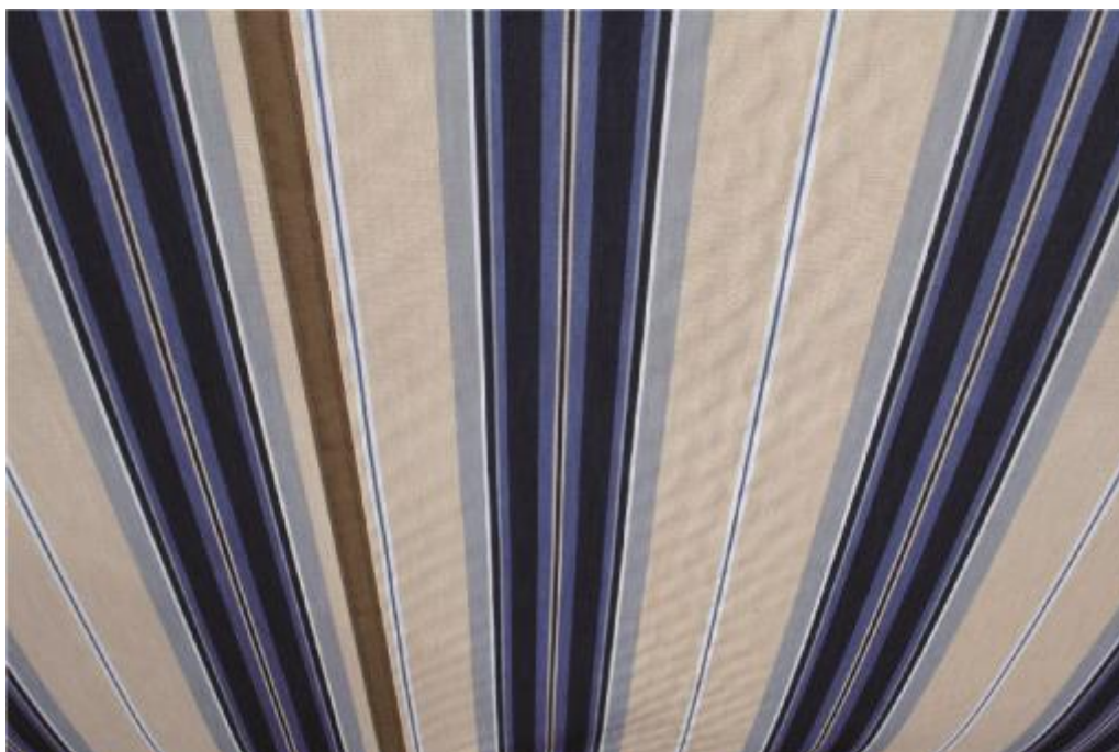
Afb. 9.1.10 Toelaatbare golving bij een baan (wafelvorming) Oorzaak: zie punt 4.2.4.2 en 4.2.6.2.
